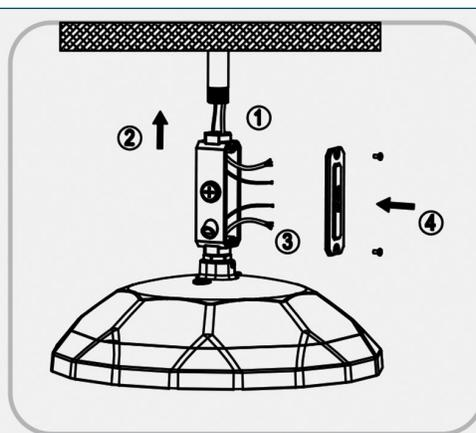
2. Faites passer le fil dans la boîte de jonction, installez la boîte de jonction sur le tube, câblez selon les exigences, prenez des mesures de protection et verrouillez le couvercle.
