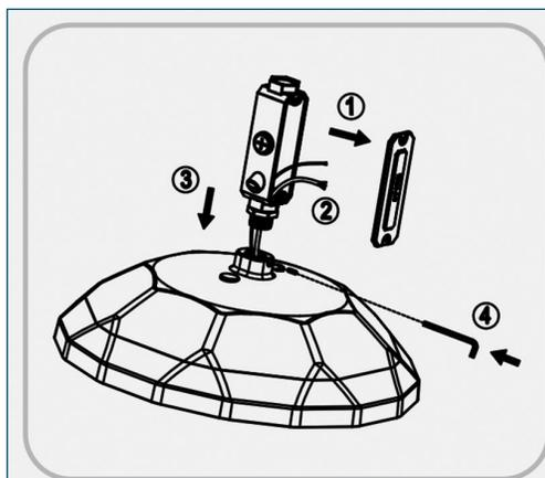
1. Retirez le couvercle, passez le fil dans la boîte de jonction, serrez la boîte de bornes et la vis de fixation.
